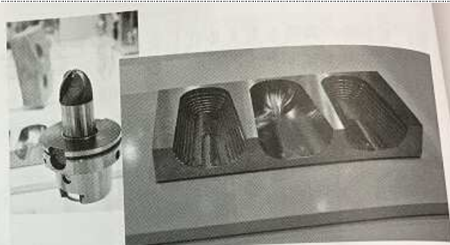
図8 外周に円弧切れ刃を有するエンドミルと切削事例 (KOMET: ドイツ)
