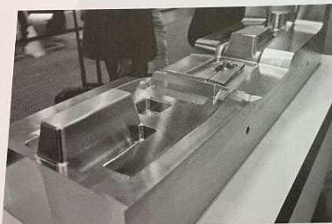
図7 5軸制御MCの小径エンドミルによる金型部品の精密切削事例 (牧野フライス製作所)
