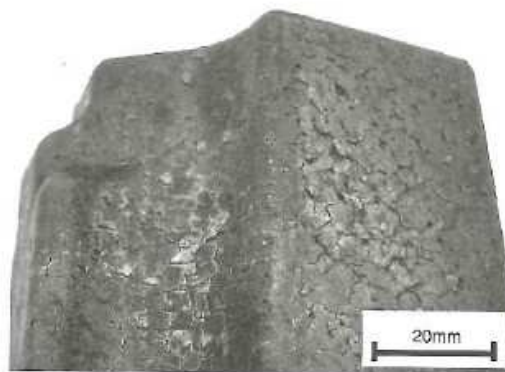
図4 金型の表面に発生したヒートチェック
