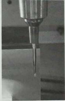
図5 モジュール化されたスローアウェイエンドミル (ダイジェット工業)
