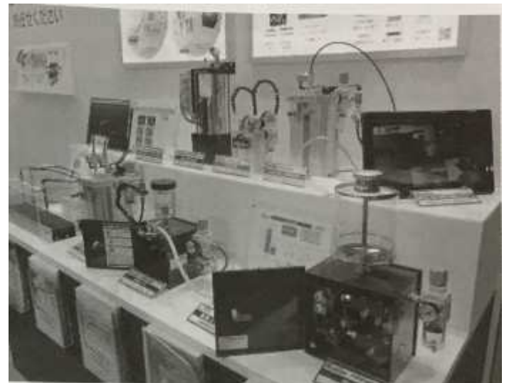
圖 14 さまざまなタイプの微量油供給システム (フジ BC 技研)
