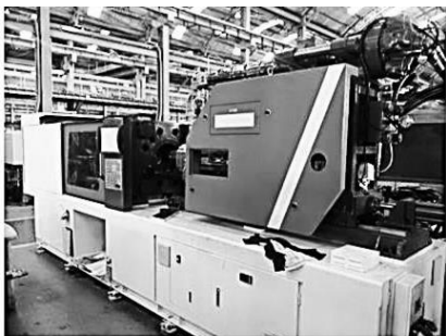
圖 4: 長纖維複合材料專用射出機示意圖
