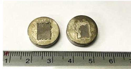
圖3-4 剪切斷面實務照
