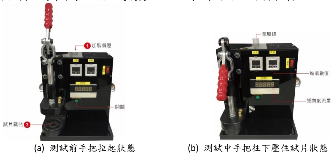
圖 3 透氣度測試機台
