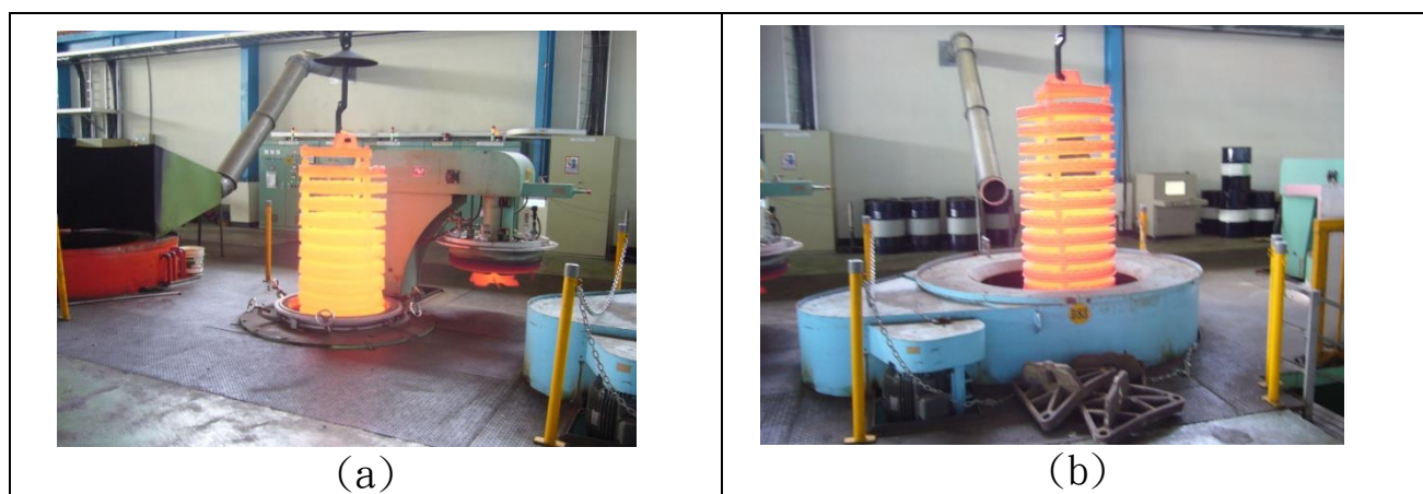
圖 3. 熱處理工廠設備:(a) 坑式氣氛保護加熱爐，(b)高分子淬火槽
