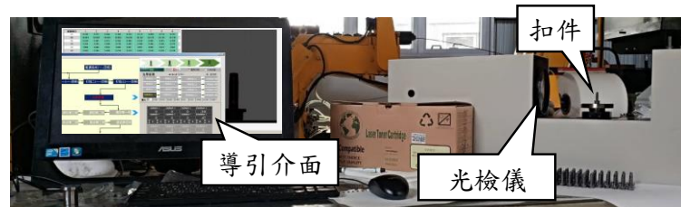
圖8 智慧調模導引系統
