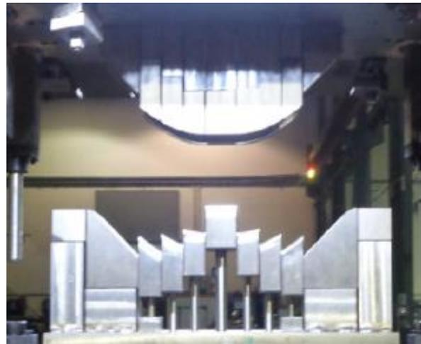
圖4 實際開發之模內彎管模具
