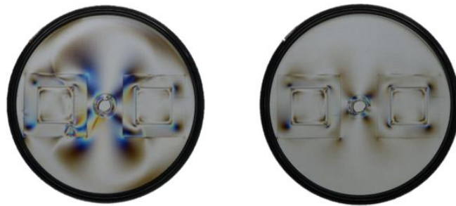
I.M.(Best parameter) I.C.M.(Best parameter) 圖 10 射出成型及射出壓縮成型成品之光彈應力分析
