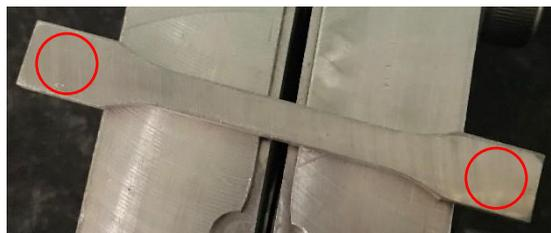
圖(4) 截取的試樣經加工完成之拉伸試片。
