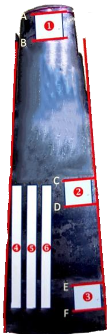
圖（4）自模具取樣之試片取樣位置及其檢驗面之示意圖。
