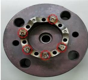
圖 14 業界模具常壓電漿氮化示意圖
