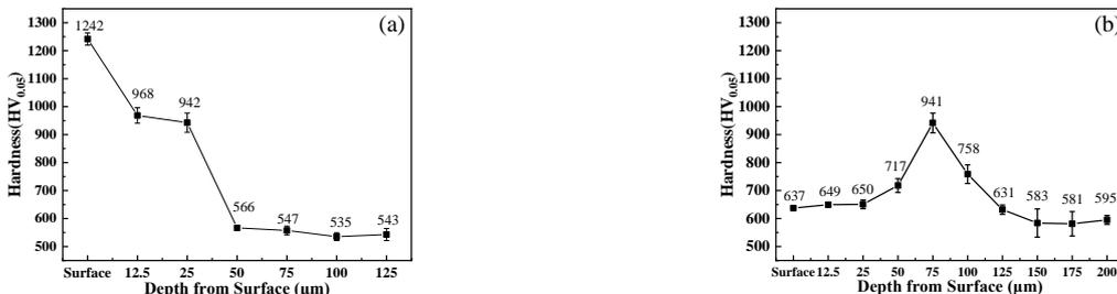
圖9常壓電漿氮化處理試片剖面硬度趨勢 (a)電漿功率為500 W、(b)電漿功率為600W
