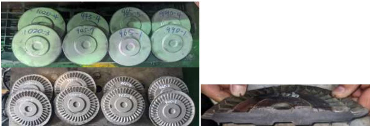
圖 9. 小批量試鍛之胚料外觀，上為預成形，下為完成鍛。右圖為流線檢驗。
