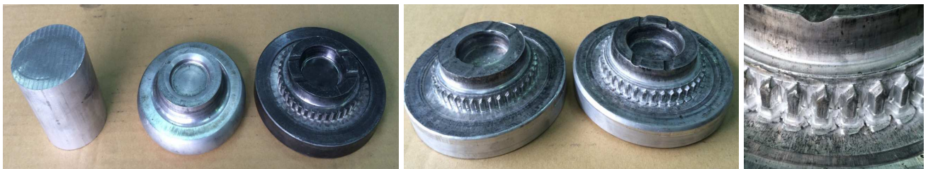
下料 熱鍛預成形 熱鍛完成離 齒形冷間垂直整形 齒形冷間側向整形 倒錐齒形
