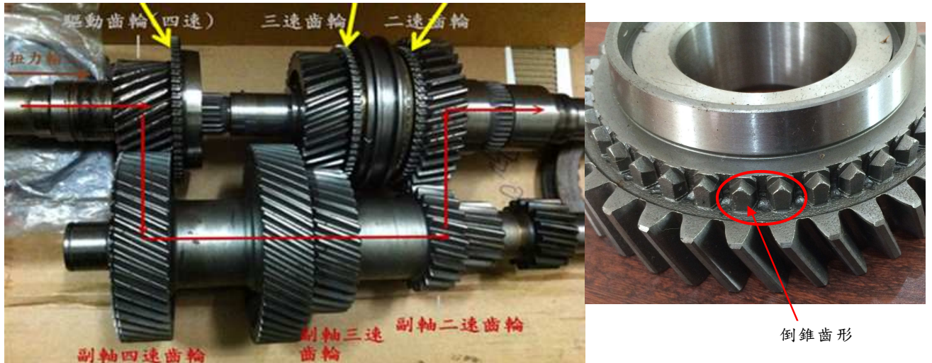
圖(1) 變速箱傳動齒輪箱內部圖與結合齒
