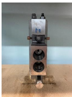
圖 8 實體一模二衝模座 圖 9 使用 SolidWorks 繪製模型 圖 10 已完成的 3D 動態模型
